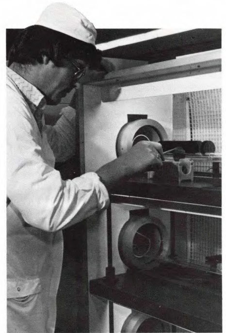
Afb. 6. In het productieproces van IC's zijn diverse ovenbewerkingen opgenomen. Hier worden siliciumplakken in de ovenslede aan-gebracht.
